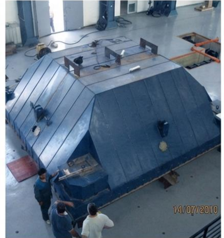
Configuration : Caissons de test sur table vibrante pour simulation de charge.
