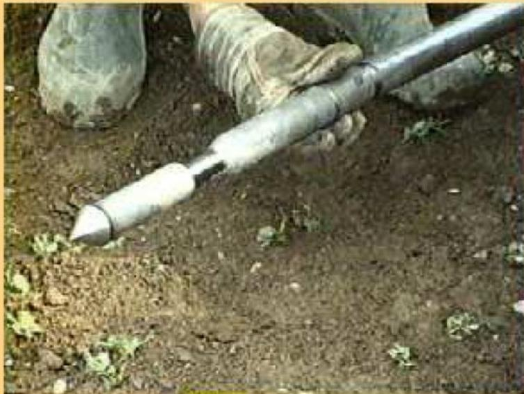
Le pénétrömètre statique est équipé d'une pointe d'une section de 10 cm<sup>2</sup> comportant 3 éléments télescopés permettant de mesurer l'un après l'autre :
