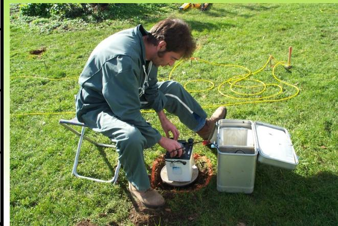
Exemple de technique géophysique : la microgravimétrie adaptée à la recherche de cavités
