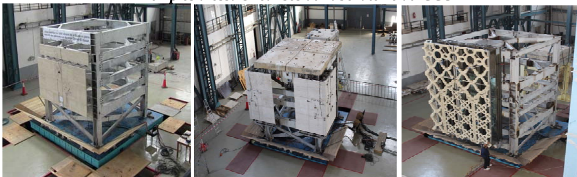
Essais de qualification sismique des éléments de façade des bâtiments du Djamaa El-Djazai
